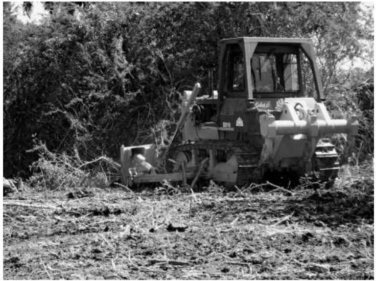
Der Cuba-Sí-Bulldozer knickt mit der Schaufel die Marabú-Stämme ab und zieht anschließend mit den Greifern die tiefliegenden Wurzeln aus der Erde.
